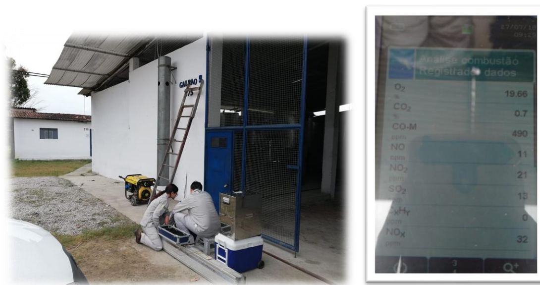
Figura 4 – Testes de emissão com engenharia de CTGAS em nossa unidade laboratorial, Macaíba (RN).
