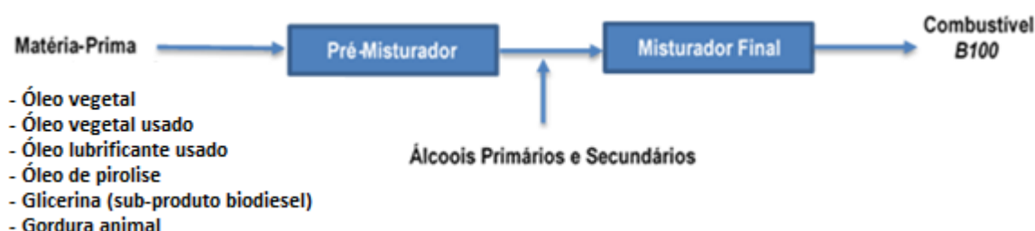
Figura 2 – Nosso novo processo de produção do Biocombustível BBL 100
