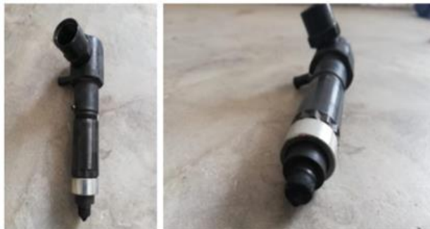
BLL DX 100 - Status dos bicos injetores do gerador Vander GDV 5500, após 2000 horas de operação
