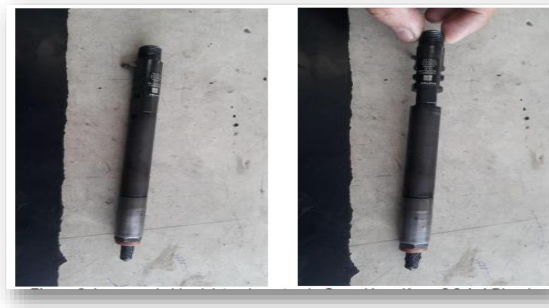
Figura 5 – Teste visual de injetores de carro após percorrer aproximadamente 40.000 km com BBL D50
