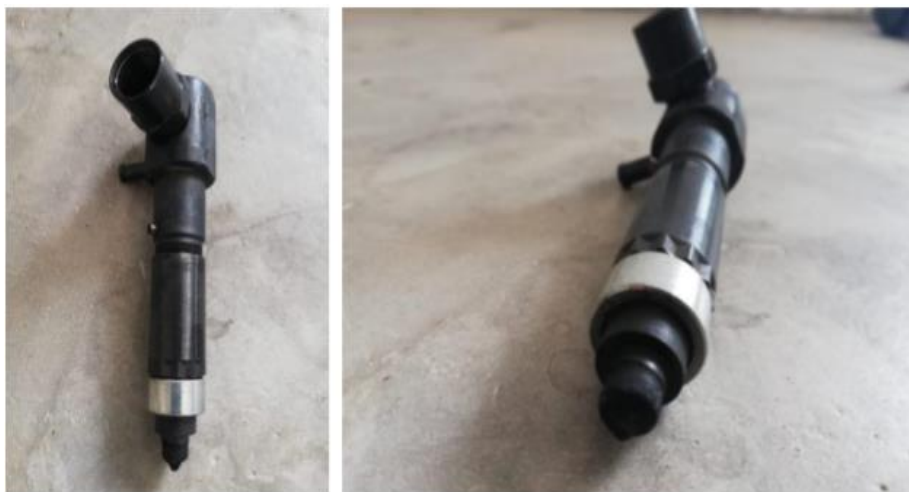
BLL DX 100 - Status dos bicos injetores do gerador Vonder GDV 5500, após 2000 horas de operação
