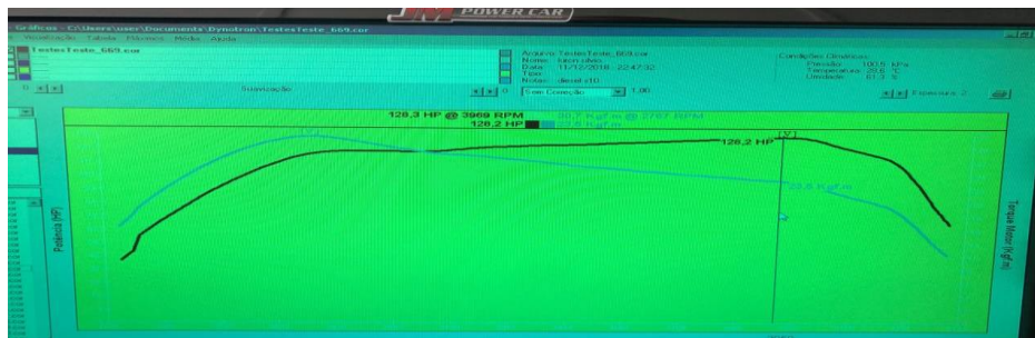
Figura 6, em cima do teste de dinamômetro realizado com aditivo Diesel S10 no mercado em 11.12.2018
